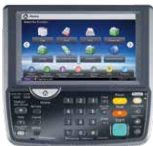
Vous pouvez accéder à tous les paramètres d'impression, de copie et de numérisation ainsi qu'à la fonction de fax en option à partir du nouveau panneau de commande avec écran tactile couleur. La grande taille du panneau de commande et sa mobilité permettent de sélectionner facilement les fonctions à utiliser.
